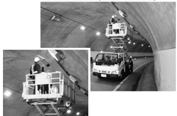
写真一2 従来型レーダー計測状況
