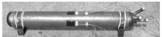
写真一1 破壊管
