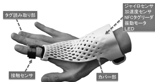
写真-1 グローブ型ウェアラブルデバイスの概要
