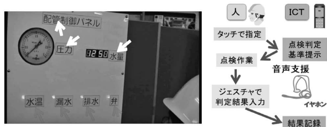
図—5 日常点検作業適用例の概念図
