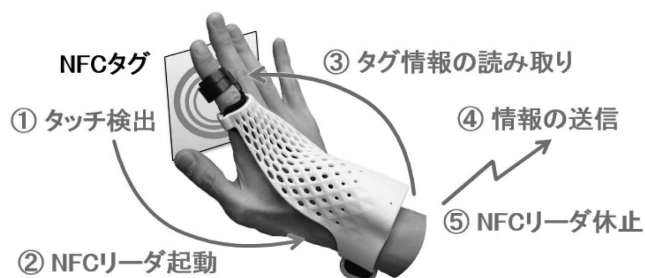
図—2 タッチイベント起点の処理フロー
