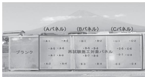
写真一5 実験対象の透光性遮音壁（記号は、パネル箇所と測定位置）
