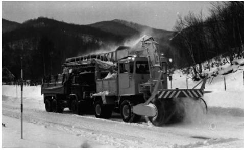
写真 2-59 (株)日本除雪機製作所 搭載式一車線積込装置付 HTR202
