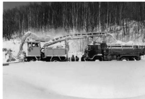
写真 2-58 (株)日本除雪機製作所 搭載式一車線積込装置付 HTR201 昭和 58 年
