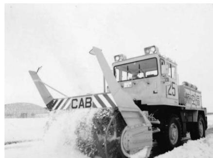
向けとして除雪幅 2.6 m, 410PS のエンジンを搭載した NR721 を開発した。
