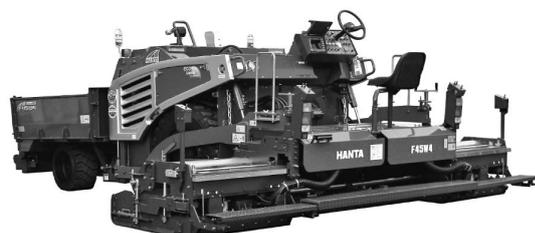
写真—2 本機2段伸縮スクリードの外観
