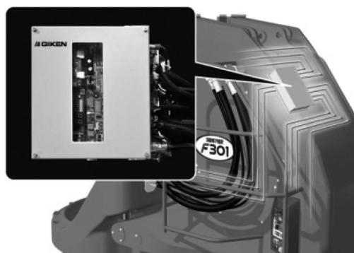
写真—2 制御システム
