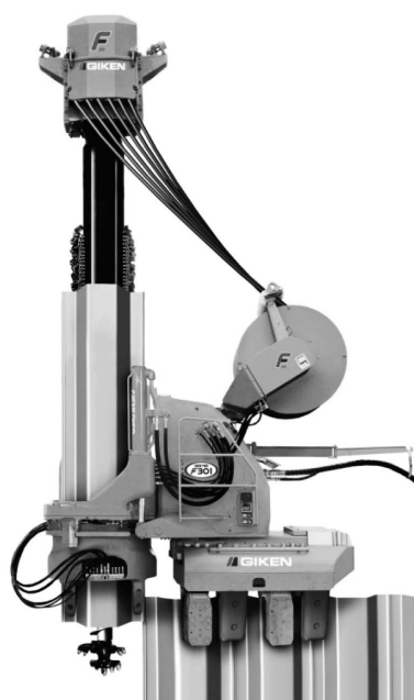
写真—1 本機（写真は硬質地盤圧入時）
