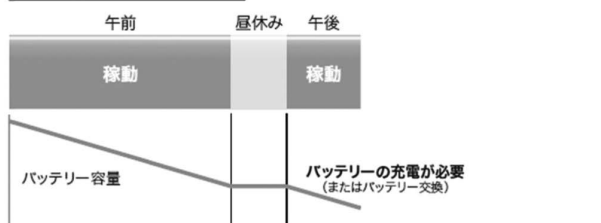
図—1 運用パターンによる稼働時間の延長効果
