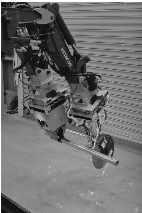
写真-3 対象を把持固定しての切断作業
