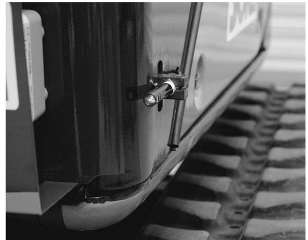
写真一八 本体側面のレーザーマーカ
