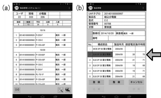
図一5 タブレットの画面を示した図。(a) 整備が行われた製品を一覧表示している。この画面では、タブレットから入力が行われた製品の実績を状態別に確認することができる。(b) 分電盤の検査データを入力する画面。矢印で示す行は、部品名の欄が赤く塗られている。この部品が品質基準を満たさず、交換の必要があることを警告している。
