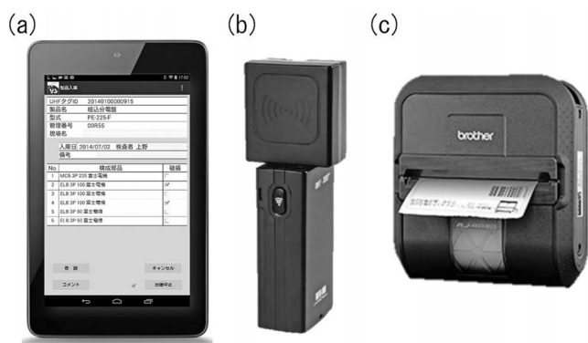
図—1 製品管理システムで使用する携帯端末。左から (a) タブレット (Google 社製 Nexus7), (b) ハンディ型タグリーダ (D.O.TEL 社製 DOTR-910J), (c) ラベルプリンター (ブラザー社製 RJ-4030) である。タブレットで動作する製品管理システムのプログラムが、他の 2 つのデバイスと Bluetooth で通信し制御する。
