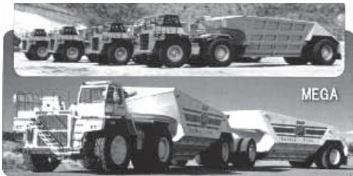
写真—44 トレーラ式ボトムダンプ
