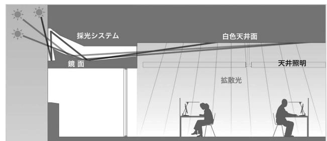
図—8 自然採光システム (T-Light Cube)
