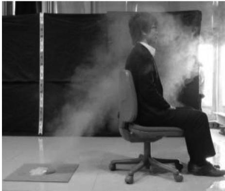
写真—5 パーソナル吹出口の気流可視化
