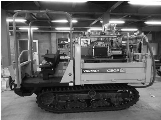
写真一 1 計測装置の搭載状況
