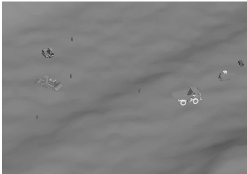
図一5 空間内に表示された建設機械，作業員，重要建設資材の3次元CG
