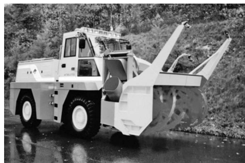
写真 2-110 HTR412（前輪操舵 - アーティキュレート切換）（株）日本除雪機製作所
