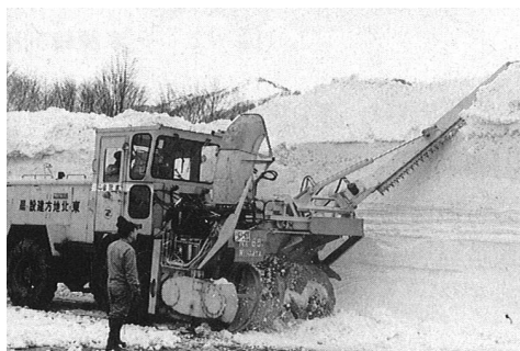
写真 2-115 東北技術事務所開発のノコギリ形高雪堤処理装置
