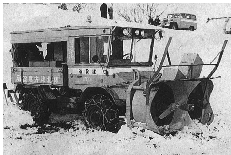
写真 2-104 ブロア形 (2 ブロア) ワンステージ 走行動力 32PS, 作業動力 110PS シュミット社 (西ドイツ) 昭和 38 年 2)
