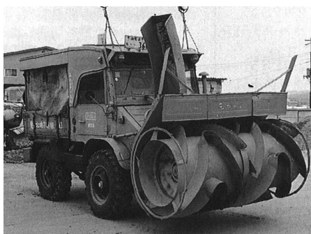
写真 2-103 シュミットカッタ形ワンステージ 走行動力 32PS, 作業動力 110PS シュミット社 昭和 37 年 2)
