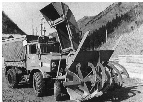
写真 2-106 リボンスクリュ、ツーステージ川崎ロールバ, KRH800 ロールバ社 (スイス) 昭和 38 年 2)
