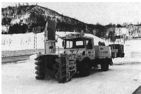
写真 2-107 立軸オーガ形、ツーステージ 450PS シュミット社（西ドイツ）TS-4 昭和62年 2)
