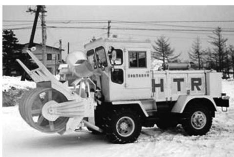
写真 2-108 HTR41（後輪ステア）（株）日本除雪機製作所
