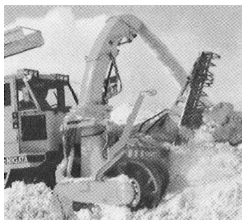
写真 2-114 スイングオーガ付ロータリ除雪車
