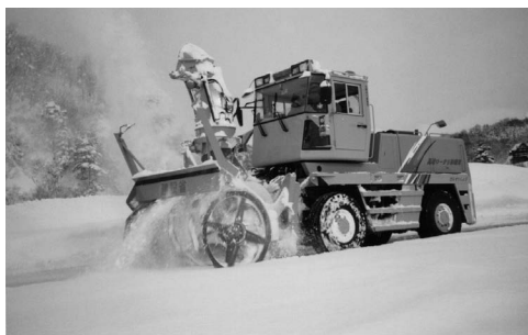
写真 2-111 ロータリ除雪車 NRS400 (4 輪操舵) (株新潟鐵工所 (注3))
