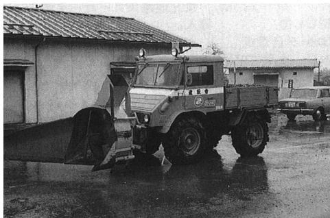
写真 2-102 ブロア形ワンステージ 32PS シュミット社 昭和 37 年 2)
