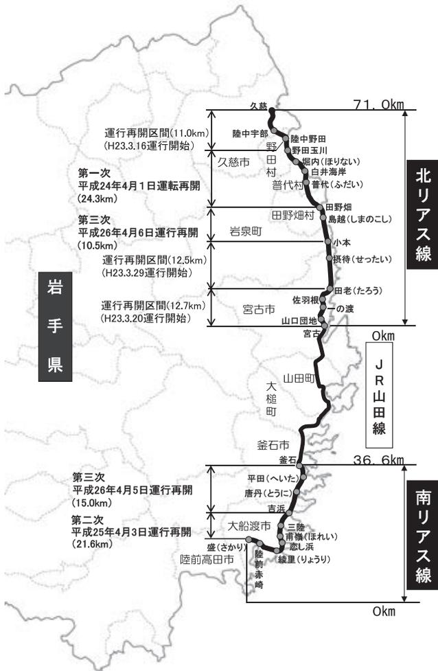
図一 三陸鉄道の路線概要図
