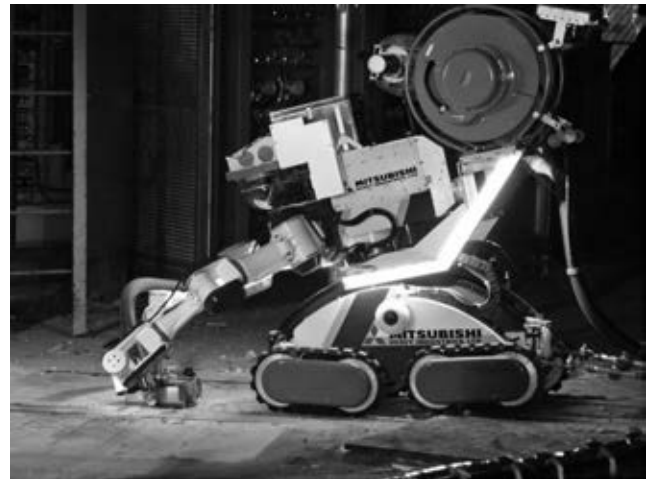
写真-7 本作業ロボット(福島第一原子力発電所内での除染作業)
