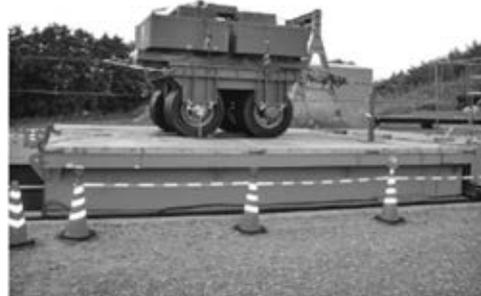
写真—2 屋外輪荷重疲労試験機（280 kN）
