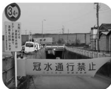
写真-7 エアー式自動交通遮断機
