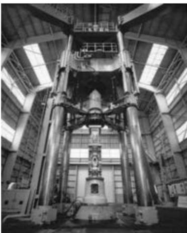
写真—1 大型疲労試験機（動的 4000 kN）
