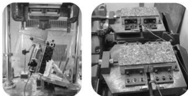
写真-6 防水層の性能評価試験機
