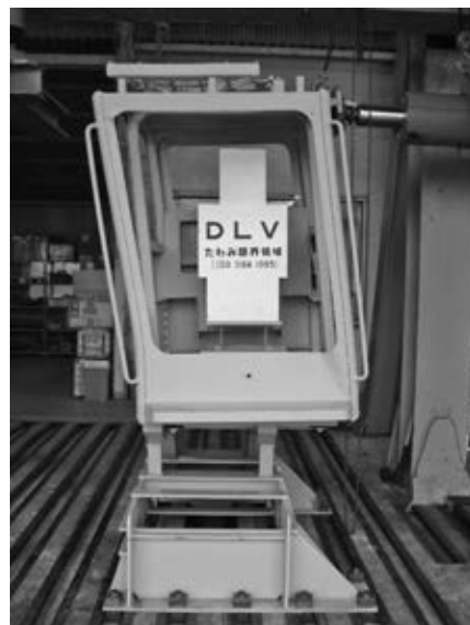
写真一 8 ROPS 側方载荷試験状況
