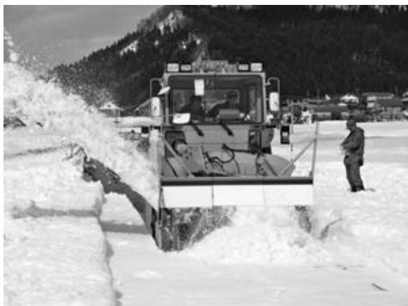
写真一 7 ロータリ除雪車試験状況
