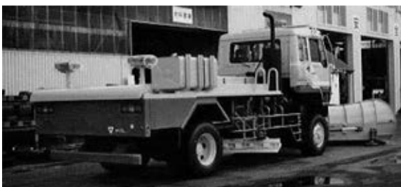
写真 3-23 10t級 4×4 除雪トラック 平成 7 年
