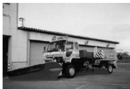
写真 3-20 オートマチックトランスミッション付 10t 級 6×6 平成 2 年
