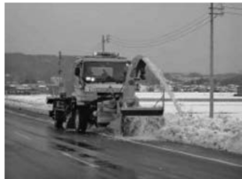
写真 3-25 10t級 4×4 多機能型除雪車 平成 14 年
