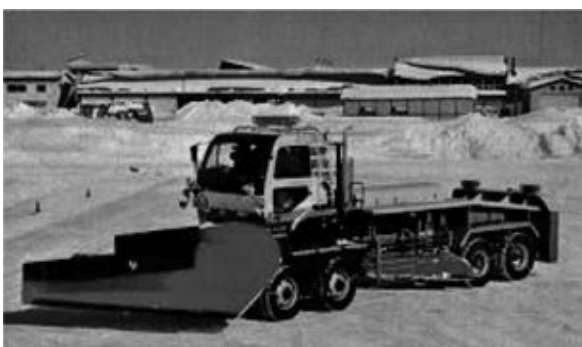
写真 3-24 10t級 8×8 高機動形除雪トラック 平成 9 年
