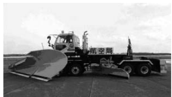
写真 3-26 10t級 8×8 空港用高性能プラウ除雪車 平成 15 年
