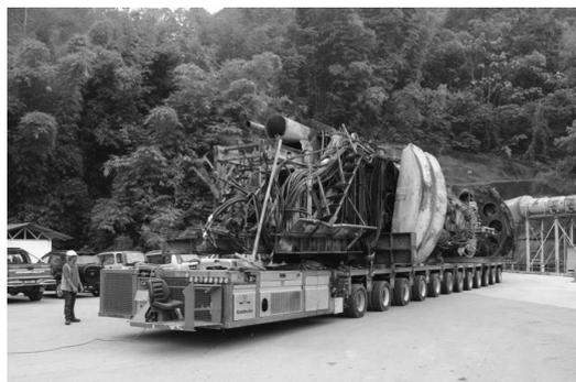
写真一 13 TBM-2 坑外搬出状況 (多軸台車にて)
