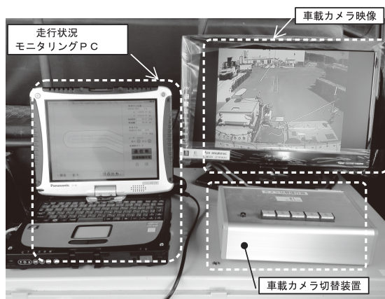
図-4 監視・指示システム (先導車内)
