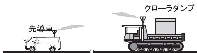
図—2 従来のクローラダンプによる搬送作業
