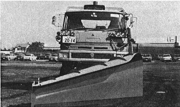
写真 3-56 昭和50年以後（かぶりが大きくなった）ワンウェイプラウ 北海道開発局<sup>1)</sup>
