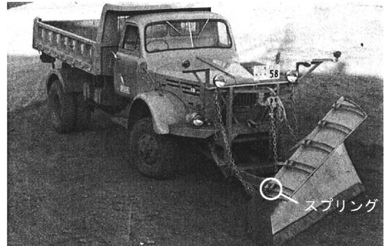
写真 3-28 スプリング付デフレクタ 北海道開発局 昭和34～40年<sup>1)</sup>
