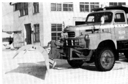
写真 3-40 安全装置作動（プラウ反転状態）<sup>5)</sup>
