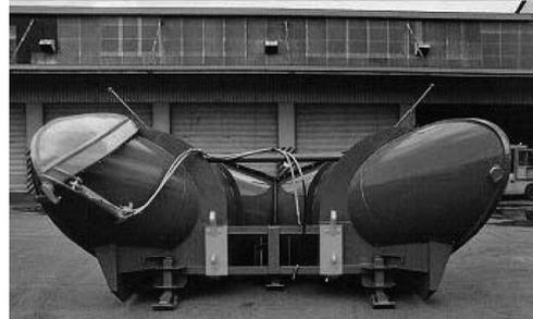
写真 3-68 ブラウ用投雪制御装置 昭和 60 年
