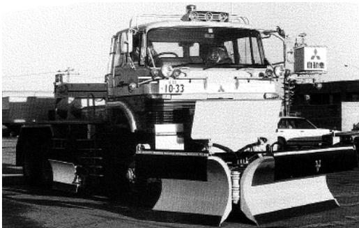
写真 3-57 高速道路用両端を折りたたみ狭小化可能な大型アングリングプラウ 昭和53年
