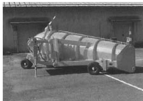
写真 3-60 左端部安全装置付きワンウェイプラウ（7t用）<sup>2)</sup>
