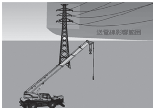
図一2 送電線近接工事の例
