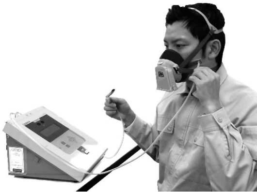
写真—6 防じんマスクの漏れ測定装置を用いた‘漏れ’測定
