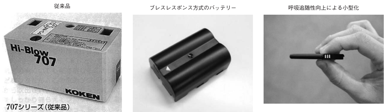
写真—8 ブレスレスポンス方式とさらなる呼吸追随性向上によるバッテリーの小型化
