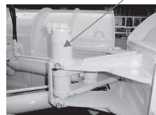
写真 3-86 プラウ折り畳み部のシャープレス安全装置 平成 19 年
