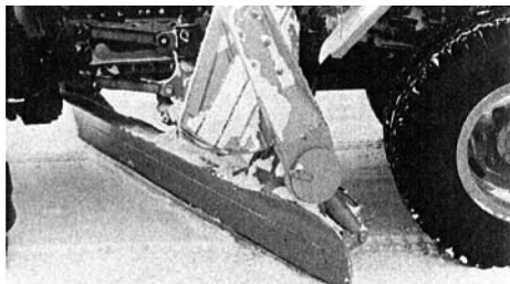
写真 3-94 シャッターを上げている状態 北海道開発局 昭和 52 年 1)
