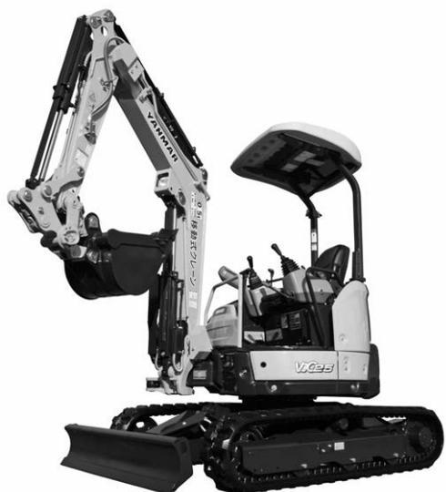
写真一2 ヤンマー建機 VIO25-6 ミニショベル（後方超小旋回型）
