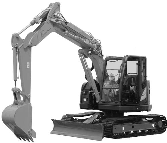
写真-4 日立建機 ZX75UR-5B 油圧ショベル（超小旋回型）
