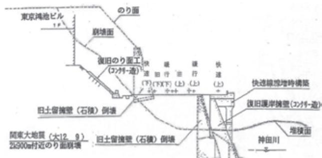
図一3 関東大震災の被害状況断面図
