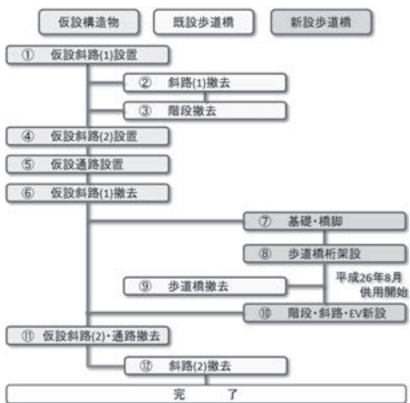
図一4 横断歩道橋付替えフロー
