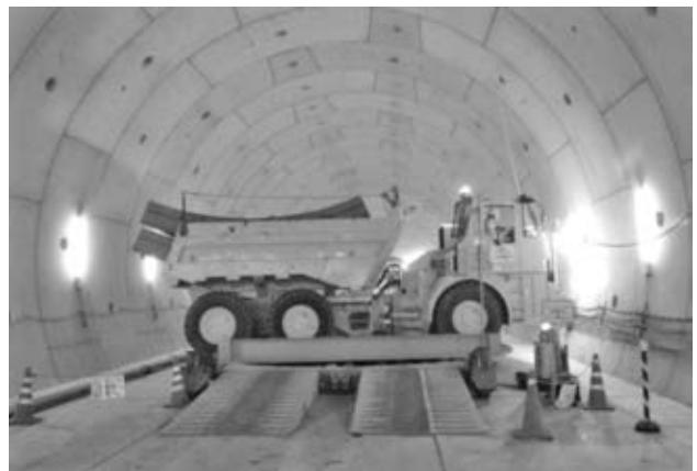
写真-3 移動式ターンテーブル
