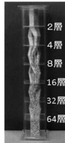
図一 6 模型による混合イメージ
