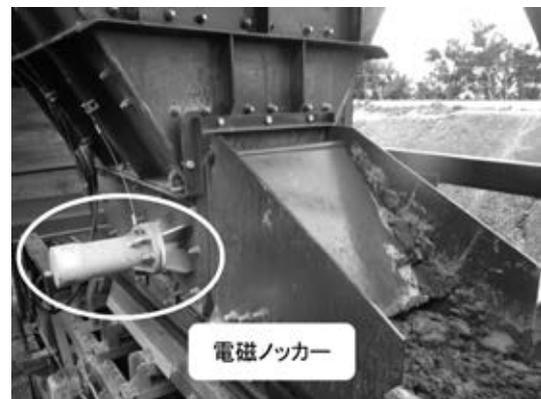
図-9 CSG 材1 投入ホッパ下部
