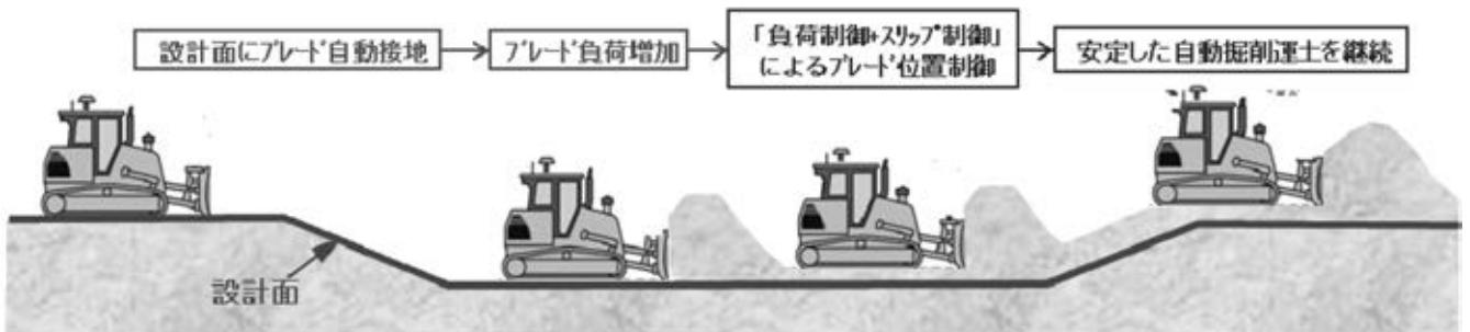
図-2 開発機による改善（作業機位置制御+負荷制御+スリップ制御）
