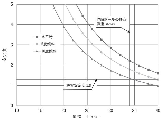
図—6 照明作業時の安定度と風速
