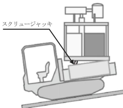
図-5 スクリュージャッキによる傾斜修正機構
