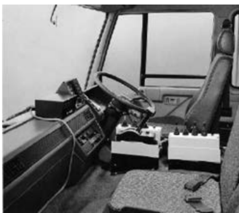
写真 3-103 トラックグレーダ自動操縦装置（モノバータイプ） 平成元年
