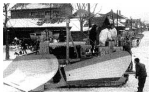
写真 3-118 ブルドーザ用サイドウイング（機械式） 協和製作所 昭和33年
