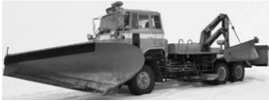
写真 3-125 後前軸上に取付けられた全油圧式サイドウイング 北海道開発局 昭和 57 年
