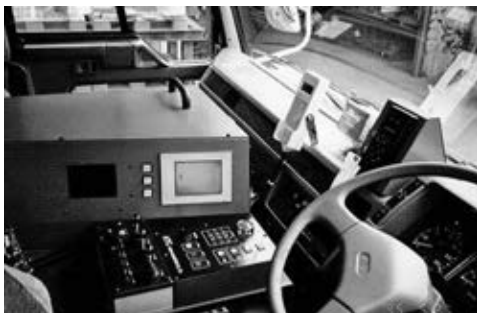
写真 3-106 トラックグレーダ自動制御装置 平成 3 年
