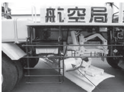
写真 3-116 皿バネ式自動復帰形安全装置 平成 15 年
