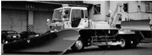
写真 3-131 3.5m 級, リンクチルト式サイドウイング 北海道開発局 平成 9 年
