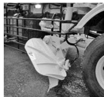
写真 3-112 ブレード用投雪制御装置 平成 11 年
