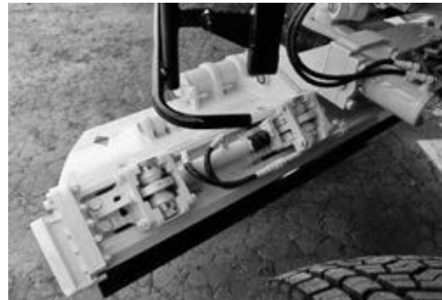
写真 3-109 横送り式エッジワンタッチ着脱ブレード 平成 4 年
