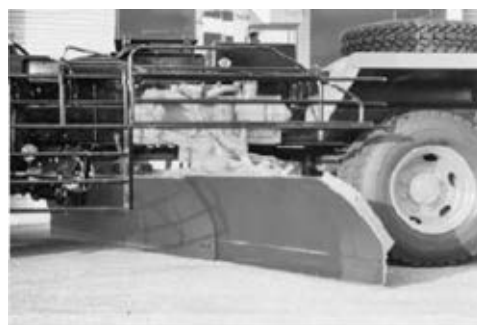
写真 3-104 伸縮型トラックグレーダ 平成元年
