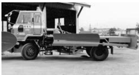
写真3-121 7t車用サイドウイング 北海道開発局 昭和59年
