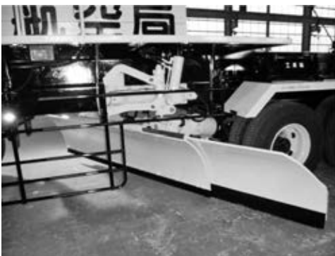
写真 3-115 空港用除雪幅連続可変式トラックグレーダ 平成 15 年
