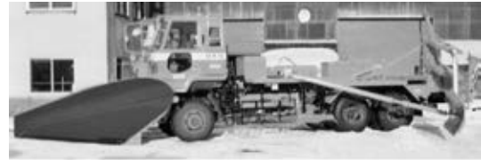
写真 3-127 全油圧式マックレー 北海道開発局 昭和 59 年
