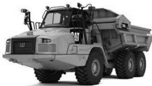
写真-6 キャタピラージャパン Cat 730C EJ アーティキュレートダンプトラック
