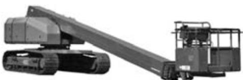
写真一九 アイチコーポレーション SR21CSM クローラ式高所作業車
