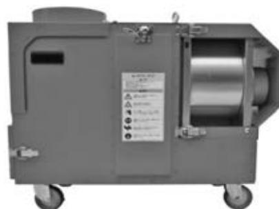
写真-7 戸田建設・新東工業・大同機械 STD-1 汎用小型集塵機 STD コレクタ
