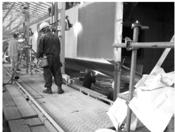
写真-4 工場溶射状況
