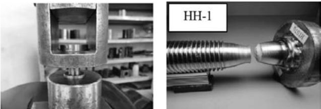
図ー6 スタッドボルトの引張試験
