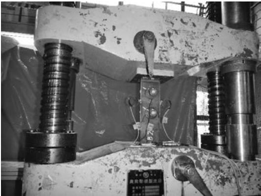
図一 11 すべり試験状況
