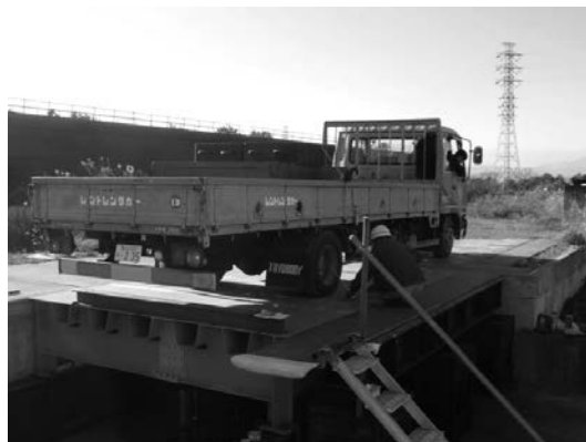
写真一 2 実トラック載荷試験の状況
