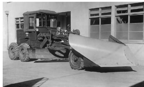
写真 4-3 3.1 m 級 65PS MGII 幌製キャブ スノープラウ付き 東日本重工業(株) (注4) 昭和 25 年
