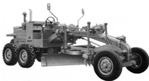
写真 4-21 3.1 m 級 110PS MG3-M 機械式 三菱重工業(株) 昭和 41 年
