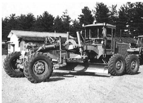
写真 4-19 3.7 m 級 定格出力 102 PS, 最大出力 115PS LG2-H 三菱重工業(株) 昭和 39 年 2)
