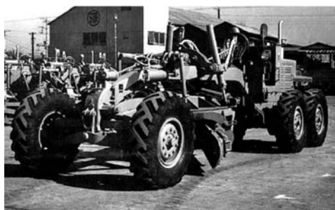
写真 4-17 3.7 m 級 定格 102PS, 最大出力 115PS LGⅡ-H 三菱日本重工業(株) (注4) 昭和 35 年 2)
