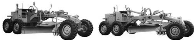
写真 4-20 共に 3.7 m 級 125PS, LG2-M 機械式(左)と LG2-H 油圧式(右) 三菱重工業(株) 昭和 41 年
