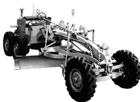
写真 4-11 3.7 m 級 初期型 100PS 後期型定格 102PS, 最大出力 115PS LG II 三菱日本重工業(株) (注4) 昭和 29 年
