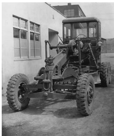
写真 4-8 3.1 m 級 初期型 80PS 後期型 105PS MGⅢ 鋼製キャブ付き 三菱日本重工業(株) (注4) 昭和 27 年
