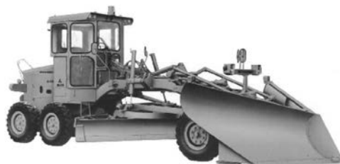
写真 4-22 3.1 m 級 110PS MG3-H 油圧式 三菱重工業(株) 昭和 42 年
