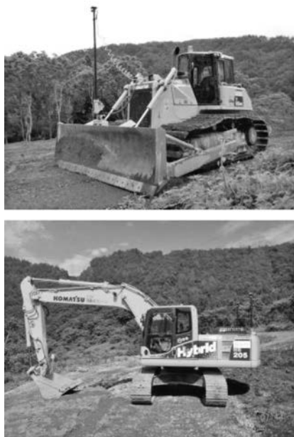
写真—1 チャレンジ工事で導入した情報化施工技術
