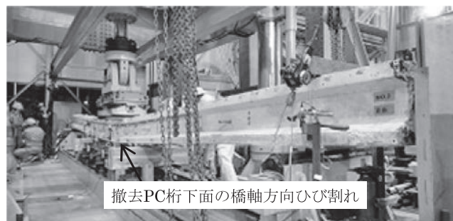
写真-6 撤去PC桁の曲げ試験
