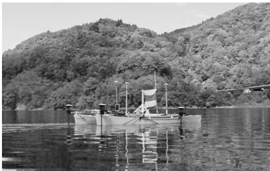
写真一 自動航行測量状況
