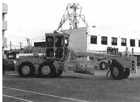
写真 4-53 4.3 m 級 320PS GH320-1B (株)小松製作所 昭和 62 年 2)
