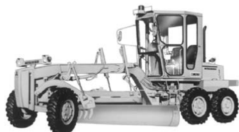
写真 4-40 2.8 m 級 95PS MG150 三菱重工業(株) 昭和 56 年
