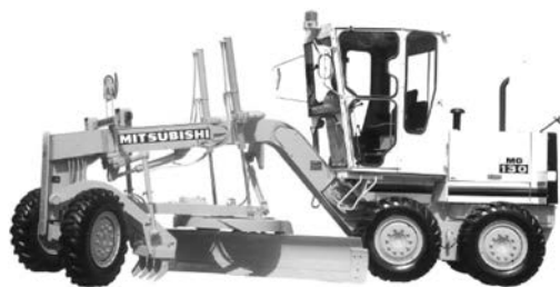
写真 4-57 2.8 m 級 95PS MG130 三菱重工業(株) 平成 2 年
