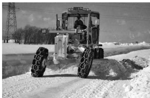
写真 4-59 4.3 m 級 320PS SR320 (E) 三菱重工業(株) 平成 8 年
