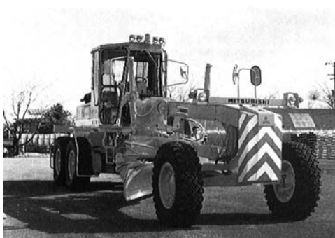
写真 4-49 4.0 m 級 230PS MG500-S 三菱重工業(株) 昭和 61 年
