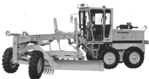
写真 4-36 3.7 m 級 150PS MG400 三菱重工業(株) 昭和 54 年
