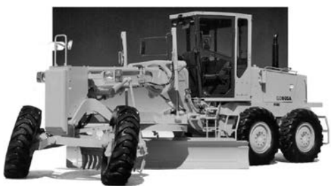
写真 4-56 3.7 m 級 157 PS GD605A-5Y (株)小松製作所 平成元年
