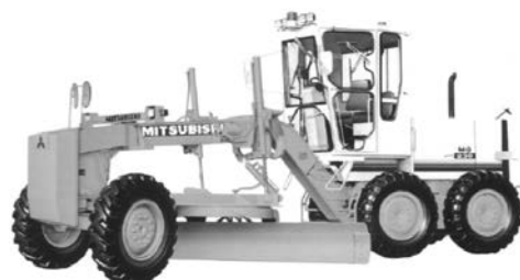
写真 4-51 3.1 m 級 115PS MG230 三菱重工業(株) 平成元年
