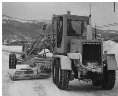
写真 4-37 3.4 m 級 125PS MG300 三菱重工業(株) 昭和 55 年
