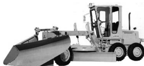
写真 4-39 2.8 m 級 80PS MG100 三菱重工業(株) 昭和 56 年
