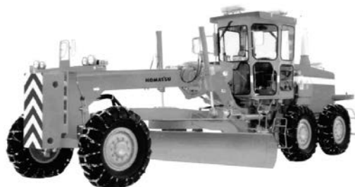
写真 4-43 4.0 m 級 230PS GD705A-4A (株)小松製作所 昭和 56 年
