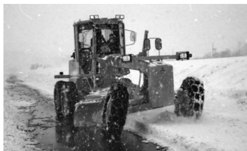
写真 4-58 4.0 m 級 230PS MG500-S (E) 三菱重工業(株) 平成 8 年
