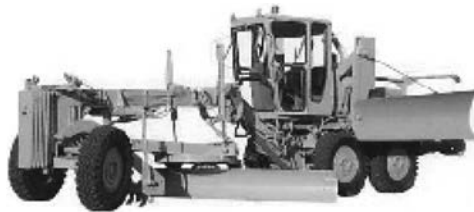
写真 4-46 4.0 m 級 230PS MG500-S 三菱重工業(株) 昭和 60 年
