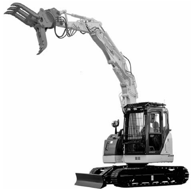
写真—8 住友建機 SH75X-6A KK 油圧ショベル（後方超小旋回型）木造家屋解体仕様
