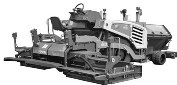
写真-9 範多機械 F1741W5 アスファルトフィニッシャ
