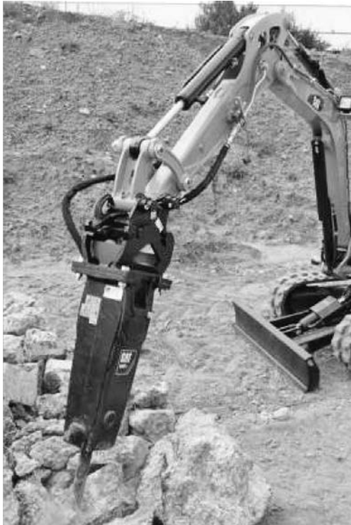
写真—7 キャタピラー・ジャパン Cat E シリーズ 油圧ブレイカ
