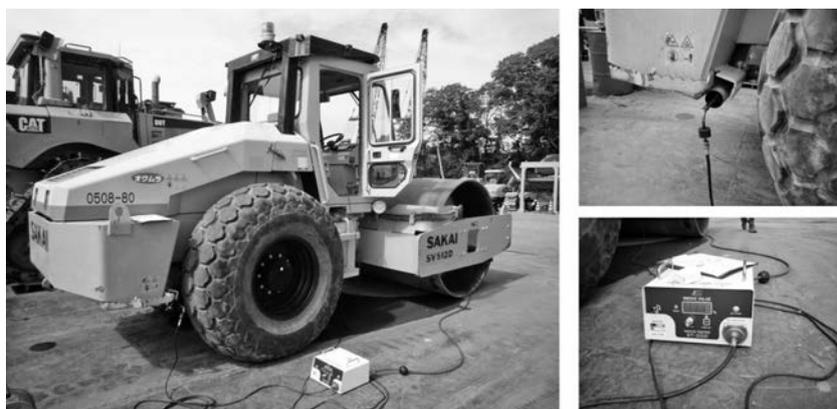
写真—3 スモーク試験の実施状況の例
