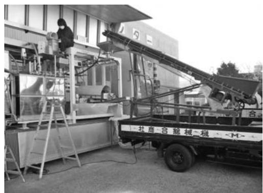
写真—4 放射能汚染土壌洗浄装置
