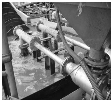
写真一2 水噴流型混合器
