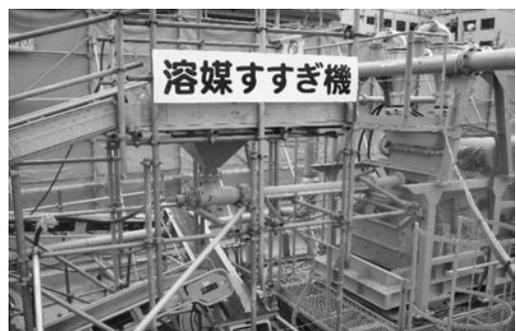
写真—5 フッ素汚染土壌洗浄装置
