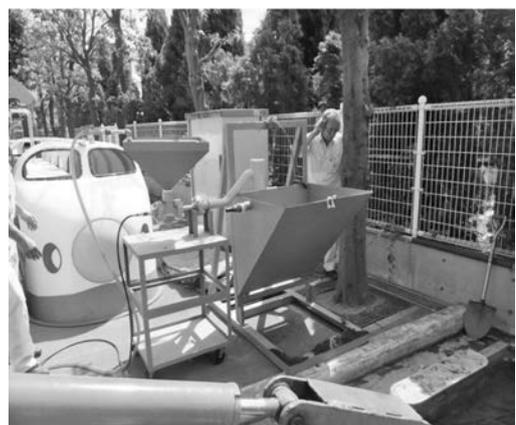
写真—6 大腸菌汚染土壌洗浄装置
