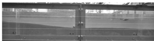
写真—3 水中における充填材の流動状況
