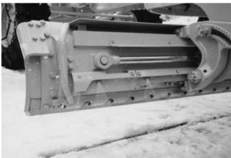
写真 4-109 溶液散布装置ノズル
