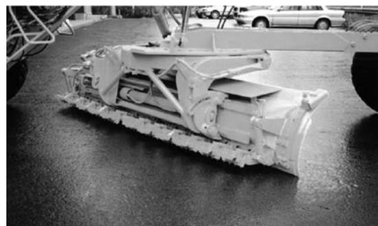
写真 4-101 粗面整形装置 三菱重工業(株) 平成4年
