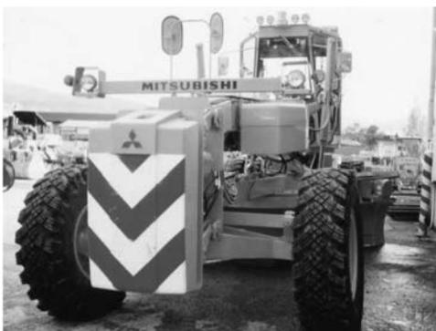
写真 4-108 MG500-S 溶液散布装置付 平成 4 年
