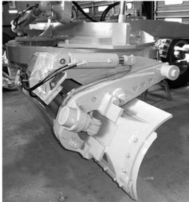
写真 4-113 シャーピンレス式ブレードチップバック装置 平成2年
