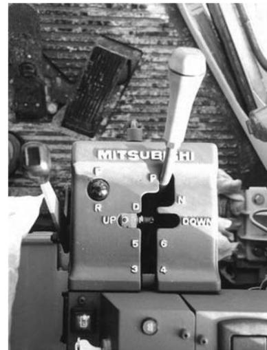
写真 4-114 ダイレクトパワーシフトによるオートマチックトランスミッションのシフトレバー 平成3年
