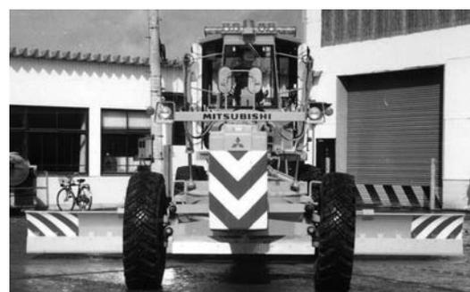
写真 4-106 作業幅員可変形ブレード (4.0m 時写真上, 6.0m 時写真下) バリアブルブレード 平成 2 年
