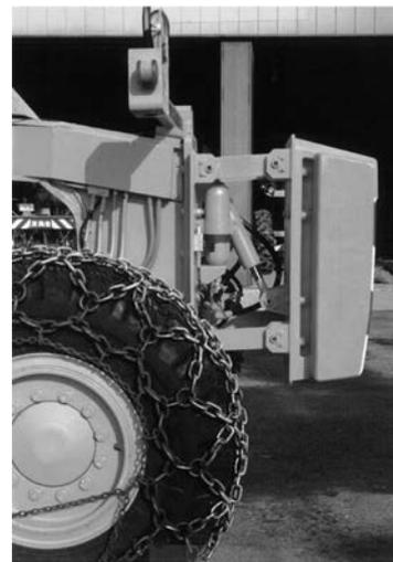
写真 4-111 ダイナミックダンパ フロントカウンタウエイト式 平成 4 年
