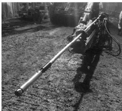
写真—1 ドリルジャンボに装着された拡縮径ビット
