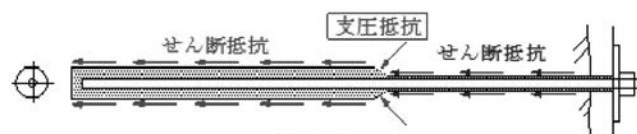
図—2 拡底ロックボルトの耐荷機構
