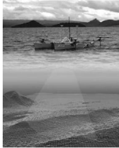
写真三 堆積物の調査ロボット
