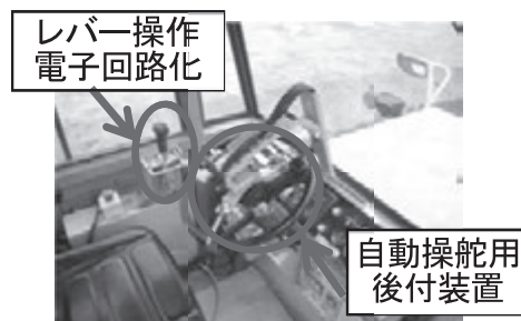
図一2 後付け自動制御装置
